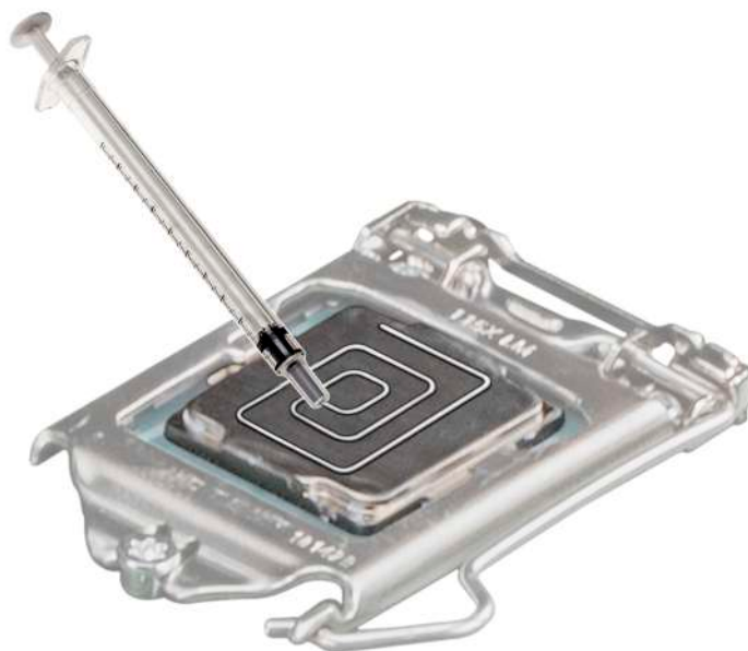
Ilustración 46. Aplicación de la pasta térmica en la parte superior del procesador
