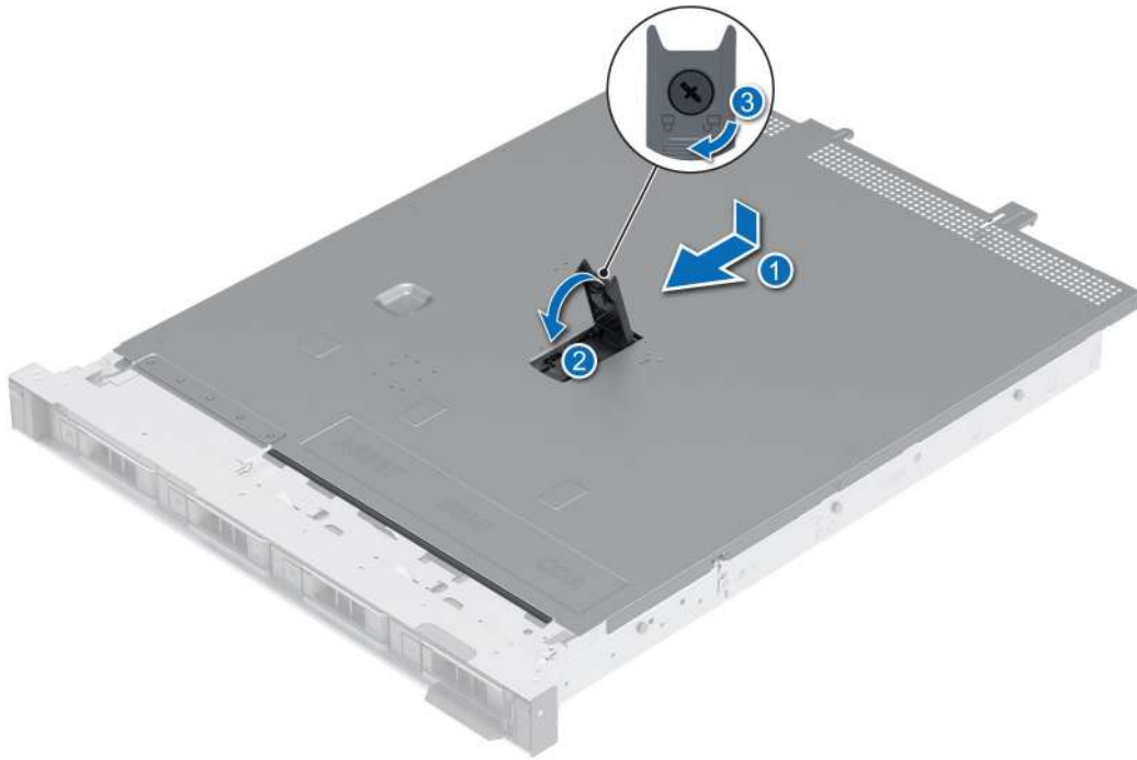
Ilustración 14. Instalación de la cubierta del sistema
