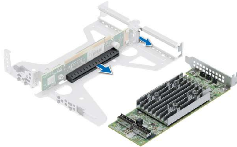
Ilustración 64. Instalación de PERC adaptadora
