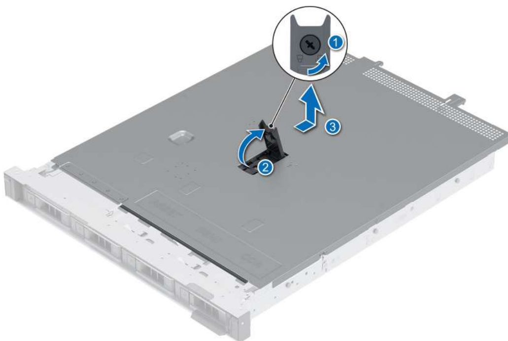
Ilustración 13. Extracción de la cubierta del sistema
