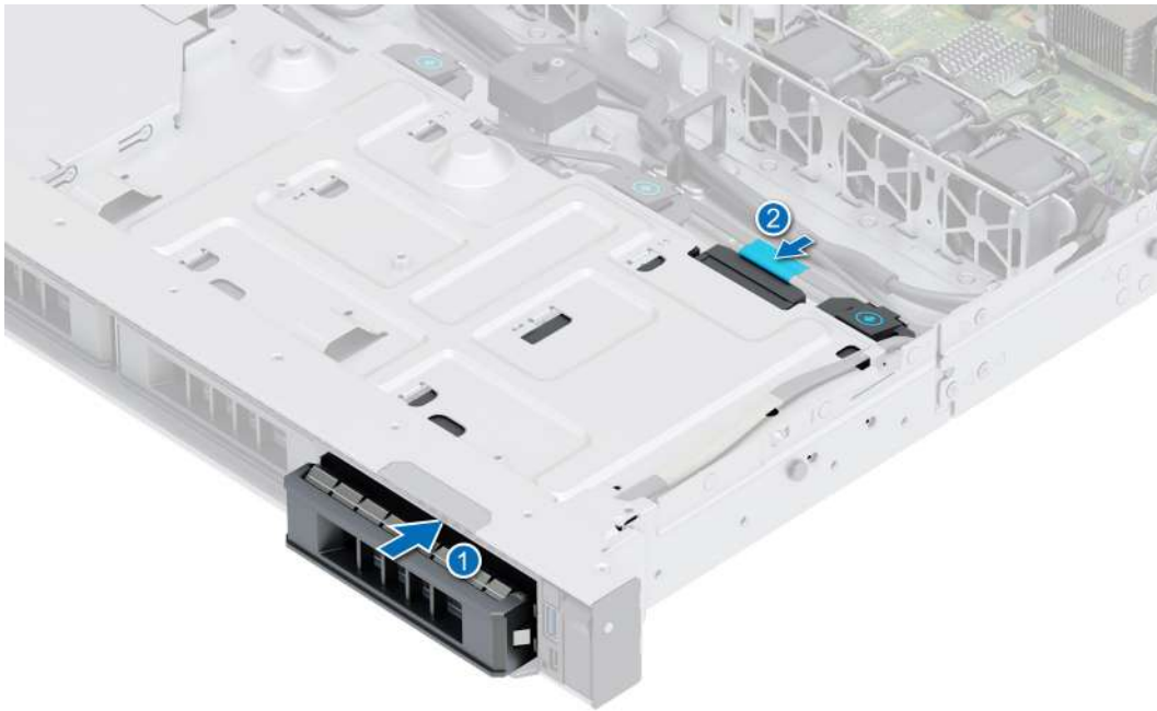
Ilustración 29. Instalación de la unidad cableada
